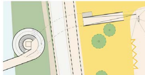
Rampe gerade (zu lange Rampe notwendig)
